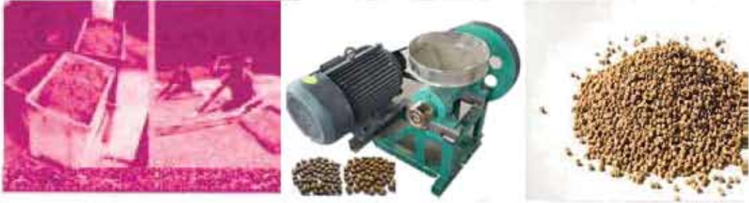
চিত্র: ক) খামার এলাকায় খাদ্য তৈরির যন্ত্র, খ. শিলেট মেলিন গ. খাদ্য শুকানো এবং সংরক্ষণ
