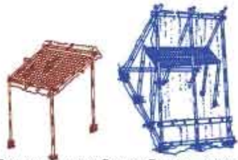
চিত্র: মাছ শুকানোর যন্ত্র। ডান: তাপ দ্বারা মাছ শুকানোর যন্ত্র।
